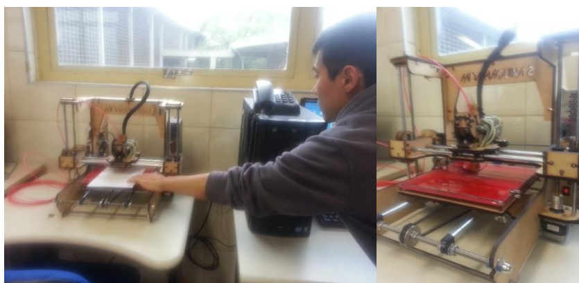
Figura 14-Monitor calibrando impressora 3D Metamáquina 2
